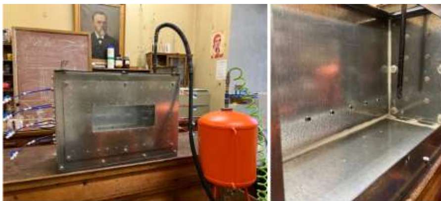
Рис. 3. Общий вид установки для инъекционного закрепления песчаных грунтов в лабораторных условиях
