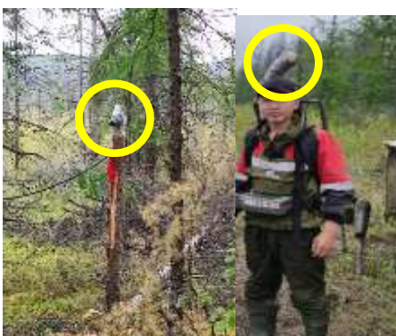
Рис. 2 Различное положение магнитных датчиков на МВС и полевом магнитометре
