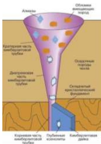
Рис. 1 Кимберлитовая трубка «МИР» и ее структурная схема
