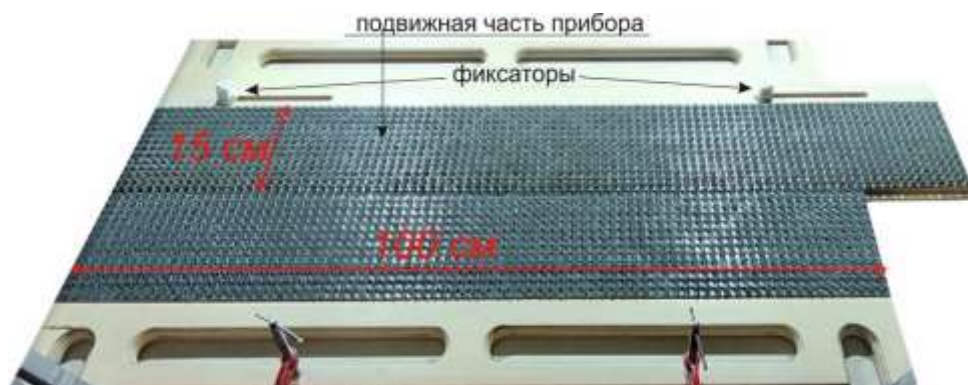
Рис. 1. Переносной прибор для моделирования обстановки простого сдвига
