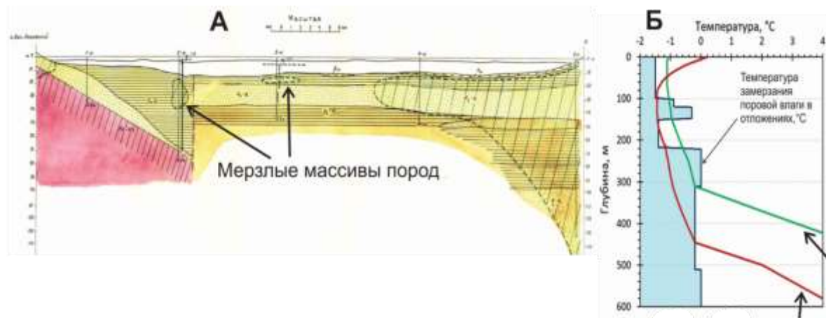
Модель температуры мерзлой толщи, свойственной поддонным глубинам 20 и 5 м.
