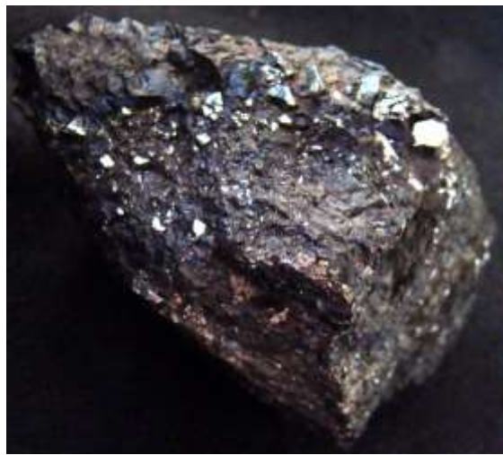
Рис. 2. Скопление метакристаллов сперрилита в моихукитовых рудах. 50x36 мм. Экзоконтакт жилы эвтектических руд. Верхи Главной Хараелахской залежи. Гор. – 430 м. Колл. и фото Э.М. Спиридонова.
