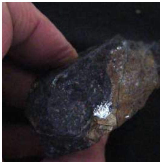
Рис. 3. Метакристалл сперрилита на контакте жилы эвтектических руд (справа) и роговиков (слева). Верхний контакт Главной Хараелахской залежи. Гор. – 430 м.
