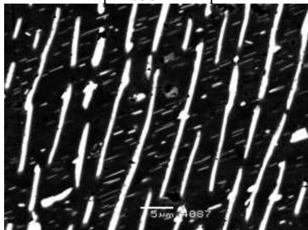
Рис. 16. Графические руды. Фрагмент блока - двойника полиморфного превращения. Матрица паоловита I. Две системы тонких ламелл распада геверсита и инсизваита (светлые), более ранние – более толстые. Главная Хараелахская залежь. Гор. –530 м. В отражённых электронах.
