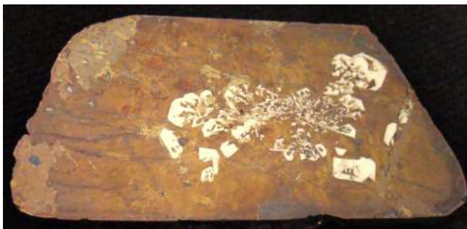
Рис. 5. Гнездо метакристаллов сперрилита в моихукитовых рудах. 65x33 мм. Экзоконтакт жилы эвтектических руд. Верхи Главной Хараелахской залежи. Гор. – 530 м. Колл. и фото Э.М. Спиридонова.
