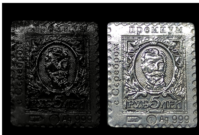
Рис. : Результаты выдержки серебряных жетонов с защитным покрытием и без защитного покрытия в агрессивной среде
