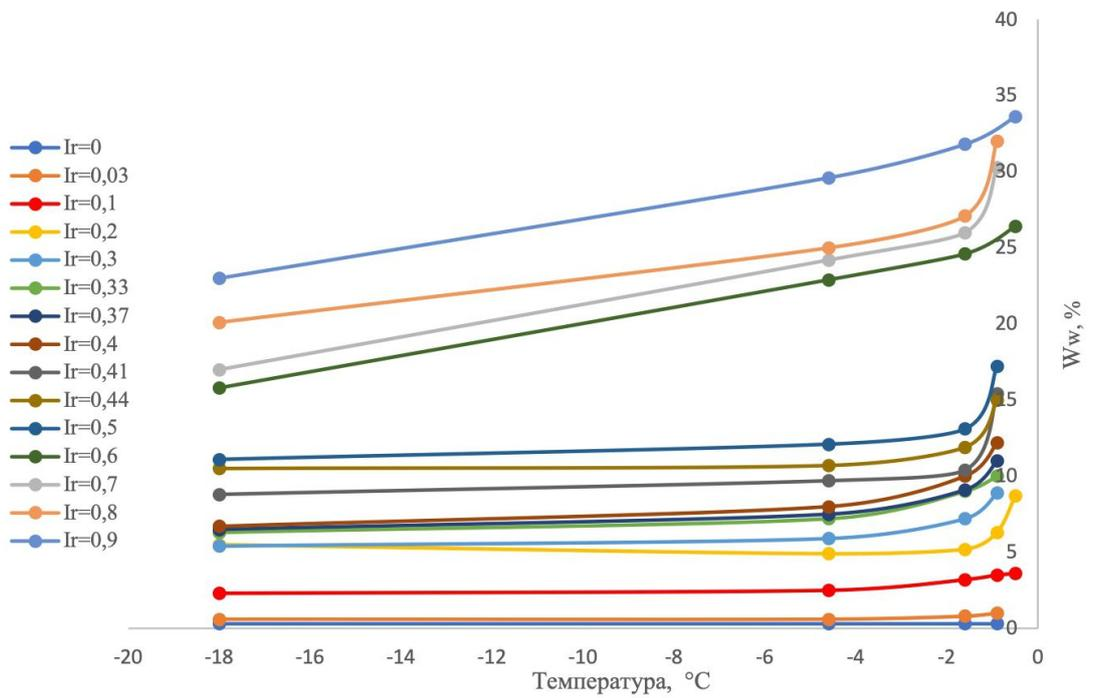
Рис. 1. Зависимость влажности за счет незамерзшей воды ( $W_w$ ) от температуры
