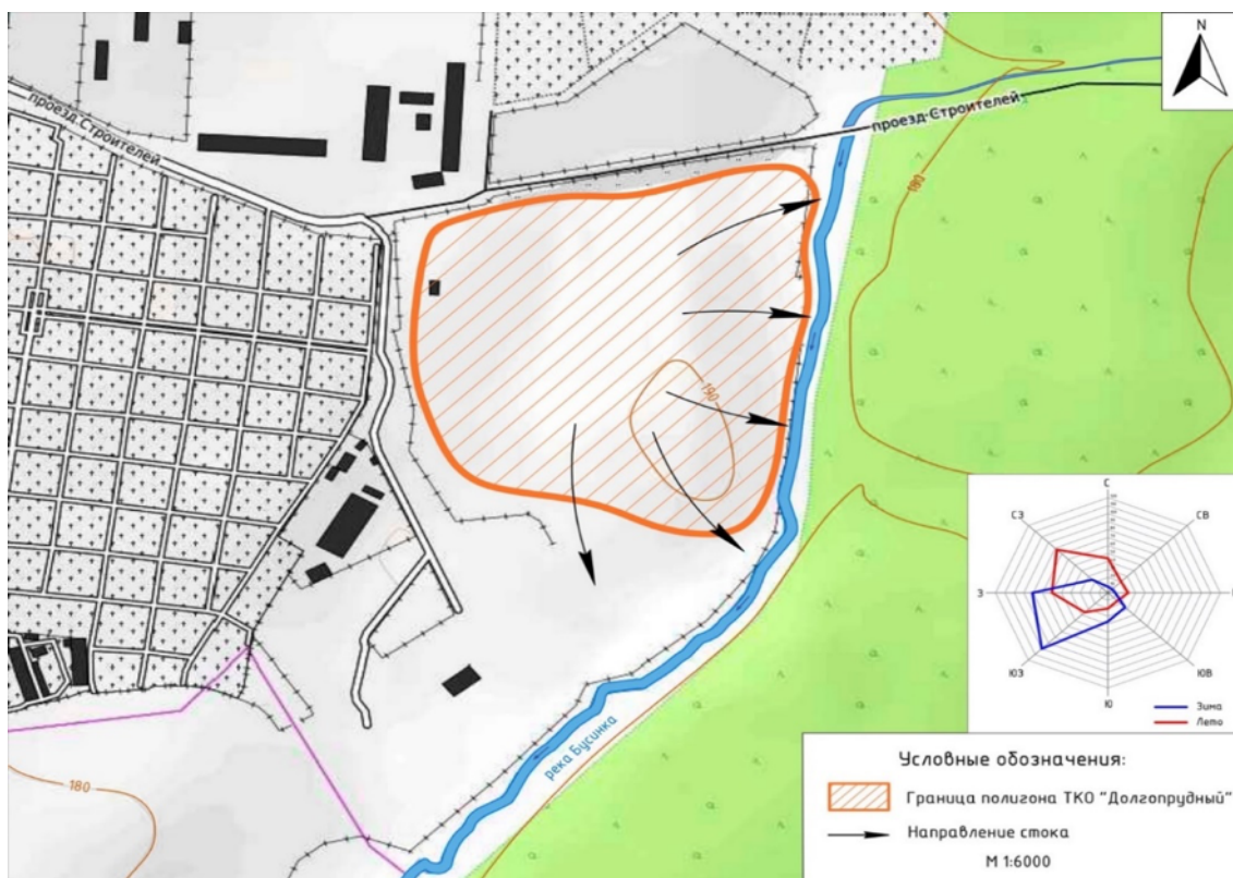
Рис. 1. Схема возможного попадания стока полигона ТКО «Долгопрудный» в р. Бусинка
