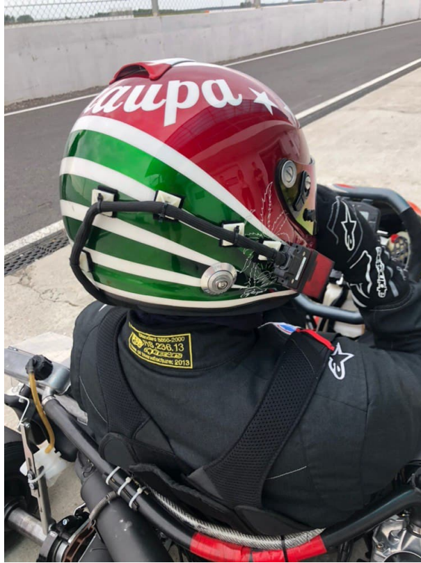
Рис. 1. Положение полиграфа на шлеме пилота серии картинг
