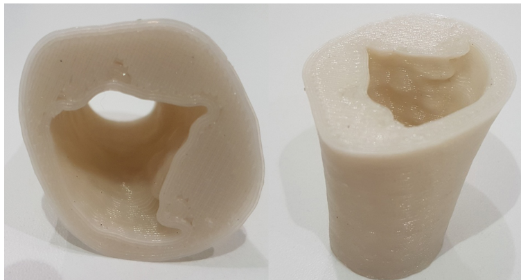
Рис. 1. Напечатанный фрагмент эпифиза большеберцовой кости модифицированным FDM методом. Размеры 6,7x4x5,6
