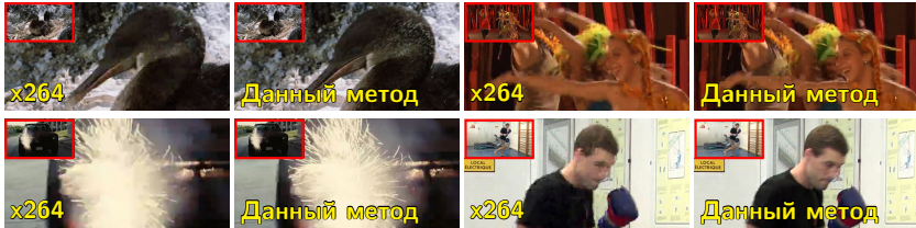
Рис. 2: Результаты предложенного подхода к сжатию видео и кодека x264 с одинаковым битрейтом (1500 kbps).
